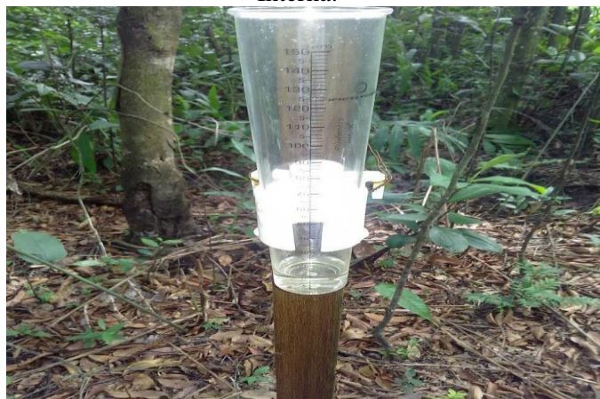
Figura 5 – Pluviômetro para coleta de Precipitação Interna.
